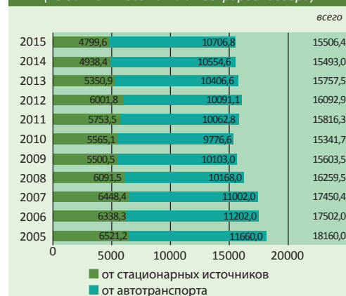
Рис. 36. Динамика выбросов оксида углерода в атмосферный воздух, тыс. т (по данным Росстата и Росприроднадзора)
