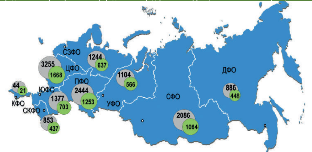
Рис. 32. Сокращение выбросов загрязняющих веществ по сценарию перевода 50% парка автотранспортных средств на компримированный природный газ в федеральных округах (по данным ПАО «Газпром»), тыс. т
