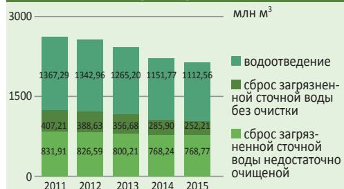
Водоотведение и сброс загрязнённых сточных вод
