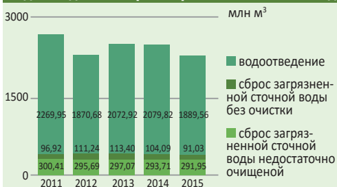
Водоотведение и сброс загрязненных сточных вод
